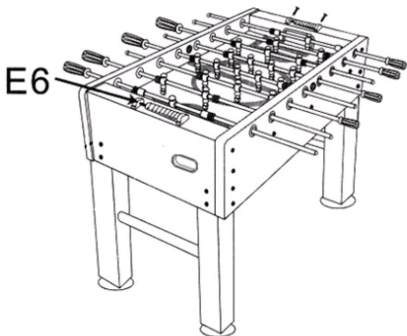
**Прикрепите счетчик к торцевым панелям на каждую сторону, используя саморезы.**
