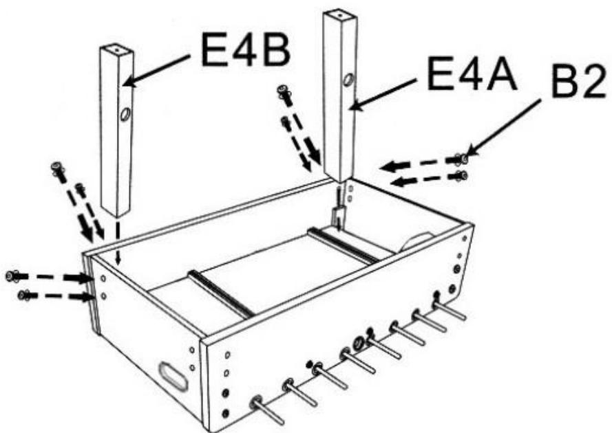
**Установите две большие ножки на нижней части стола и закрепите их при помощи болтов.**
