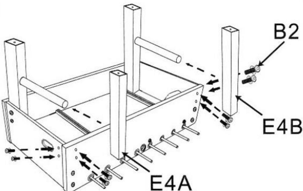
**Установите оставшиеся две ножки на нижнюю часть стола с помощью болтов.**
