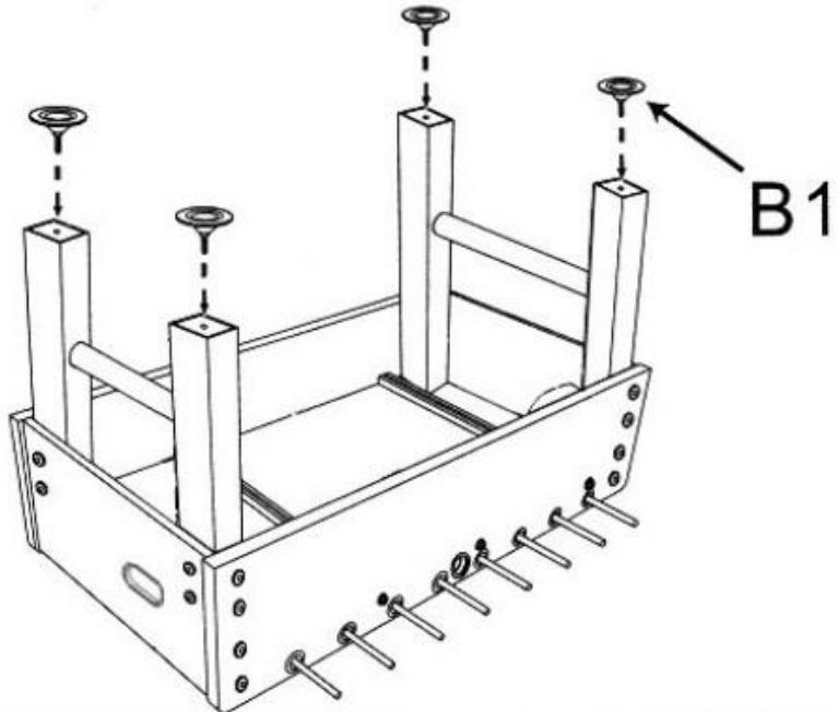
**Закрепите четыре накладки винтами на нижние части ножек.**
