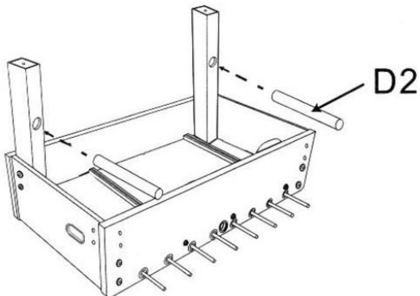
**Вставьте стальные распорки в нужные отверстия установленных ножек.**
