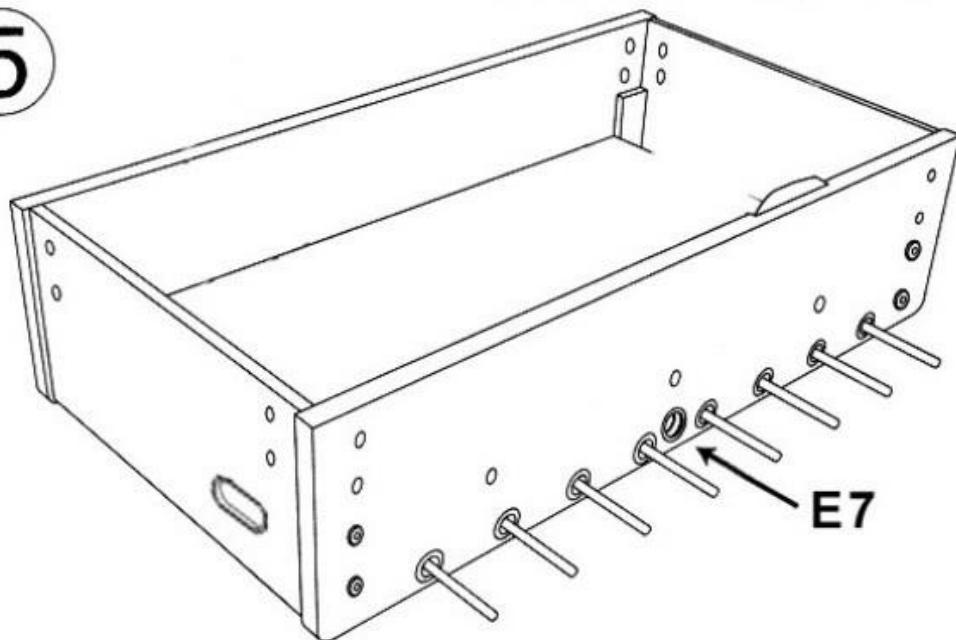
**Переверните стол, соедините ворота и подачу мяча пластиковым тонелем, закрепите детали винтами.**
